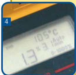
**Bild 4:** Die hier als Beispiel abgebildete Probe beinhaltet 1,3 Gew.% Wasser.
